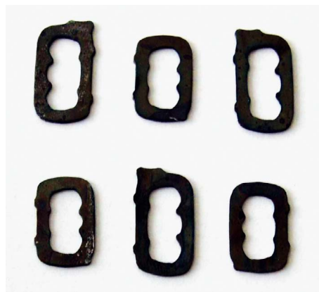
Bainitvergütete Kettenlaschen für Multitronic-Getriebe müssen hohen Betriebsbelastungen standhalten
